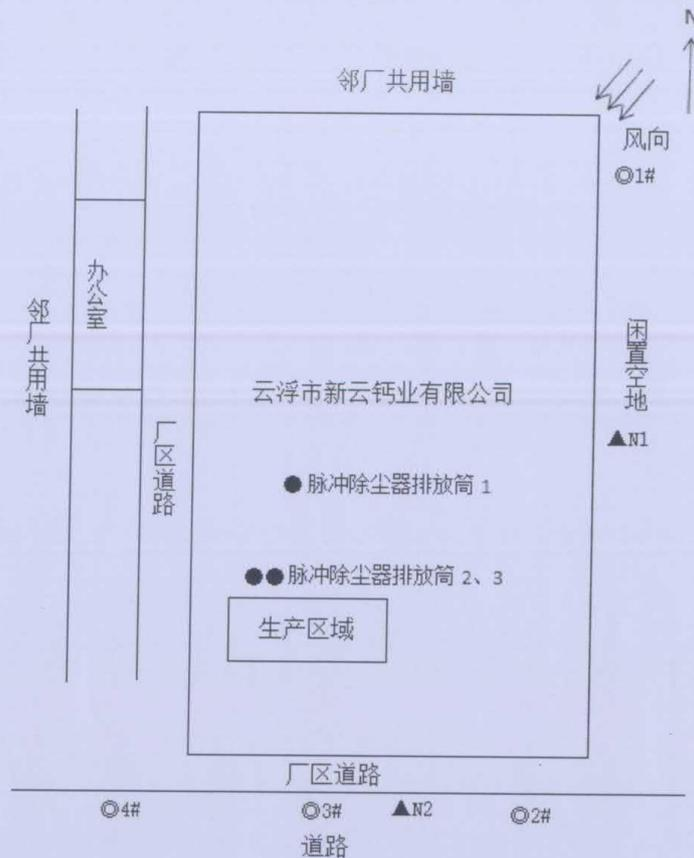
图 1 监测布点示意图 (○无组织废气监测点位 ●有组织废气监测点 ▲厂界环境噪声监测点位)
